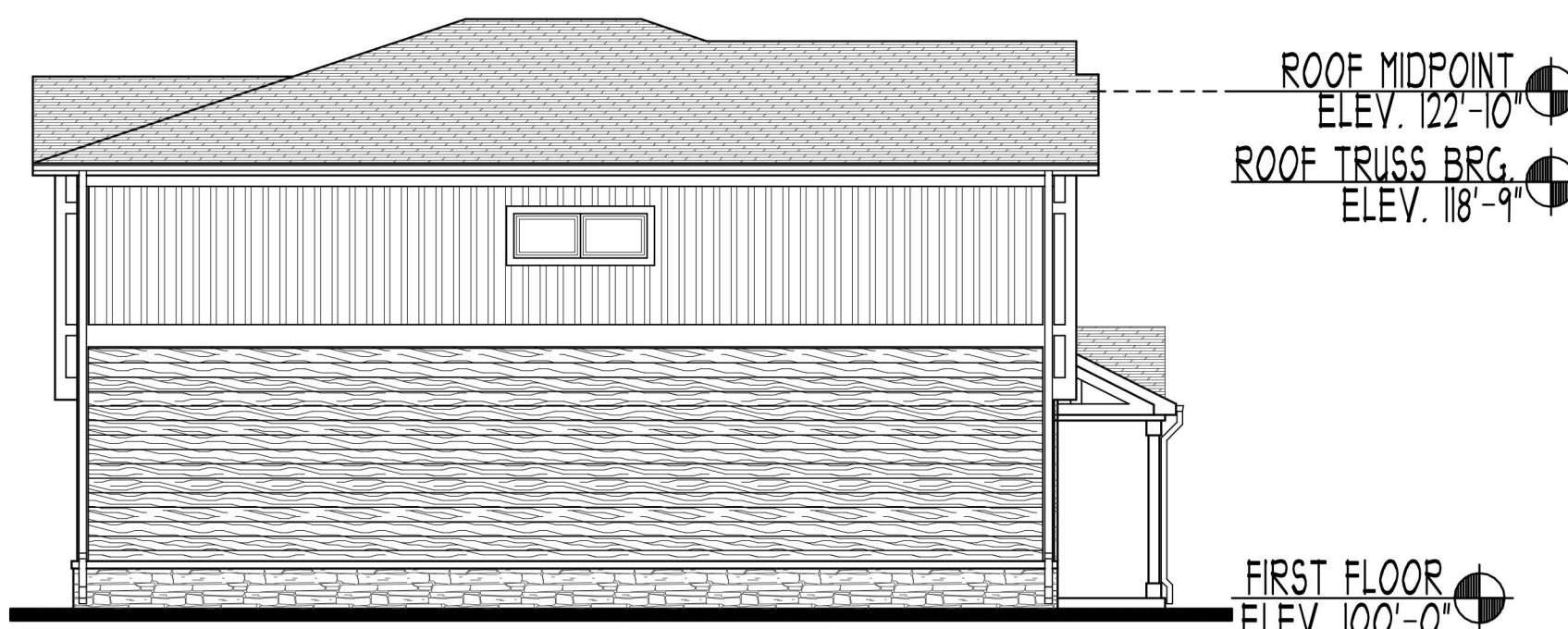
RIGHT ELEV. - 5 UNIT BLDG. SCALE: 1/8" = 1'-0"
